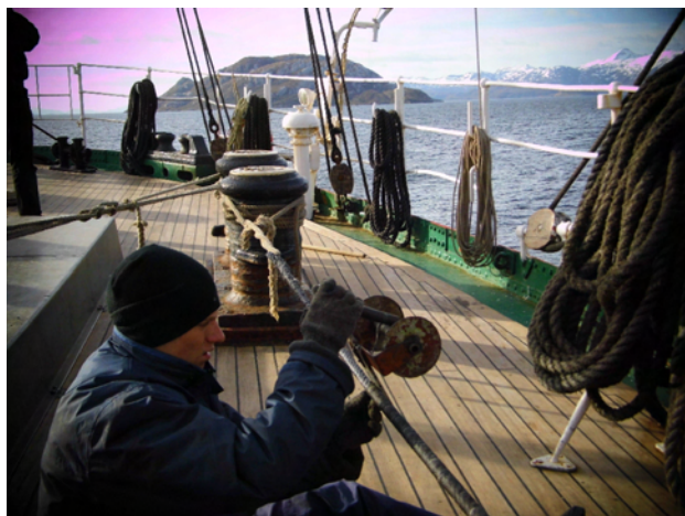
Bekleiden von Drahttauwerk
